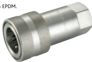
Hydraulische snelkoppeling RVS - ISO 7241-1B - BSP female
