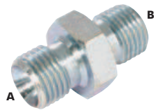
2 x BSP male 60° binnenconus - met restrictor - onbehandeld
